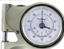
Divisione 1/100 mm. Adatti per misurare rapidamente e con precisione spessori di carta, cartoni, plastiche, metalli ferrosi e non ferrosi ecc. Tipo tascabile. Chiusura automatica a pressione costante.
